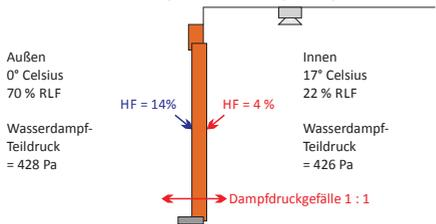
Lüftungsanlagen mit Wärmerückgewinnung führen in der kalten Jahreszeit zu geringen Raumluftfeuchten. Die innenseitige Türblattoberfläche trocknet entsprechend stark ab, ein Türblattverzug wird begünstigt.
