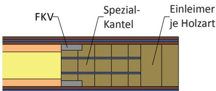
Die patentierte Spezial-Kantel beim Türblatttyp Allwetter/W weist zusätzliche Dampfsperrschichten auf. Dadurch wird das Holzfeuchtegefälle im Türblattkern und damit ein Türblattverzug verringert.
