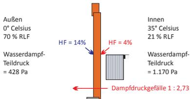
Das Vorhandensein eines Heizkörpers im unmittelbaren Türnahbereich bewirkt ein starkes Heruntertrocknen der innenseitigen Türblattoberfläche.
